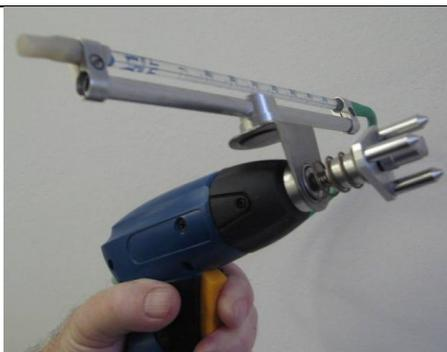
Obr. 9a. Mikrotrubice pro měření nasákavosti
