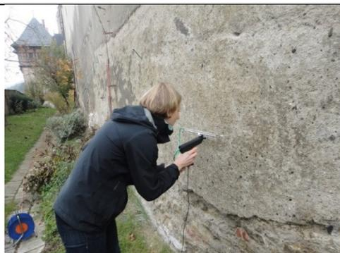
Obr. 9b. Měření absorpce vody ref. omítkou
