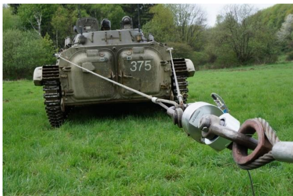
Obrázek 14 Ukázka měření výkonových parametrů vozidla BVP2 (foto P. Zerzán)
