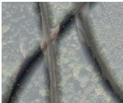
Obrázek 9. Superpozice přepočítané cenové mapy pomocí fuzzy množin (šedá škála), zaznamenané polohy vozidla PANDUR II a ortogonalizovaného leteckého snímku.
