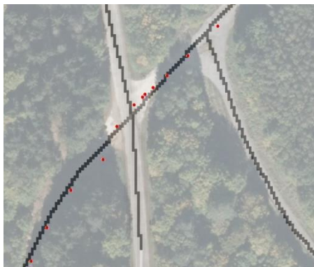
Obrázek 8 Zobrazení rastrového formátu záznamu cesty v superpozici s ortogonalizovaným leteckým snímkem. Červené body jsou záznamem polohy vozidla PANDUR II při terénních testech.
