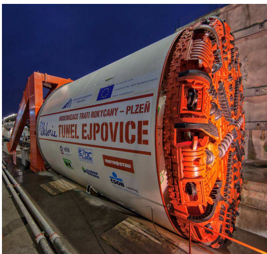
Obr.10 Konvertibilní plnoprofilových tunelovací stroj průměru 9,84 m před zahájením ražby tunelu Ejovice
