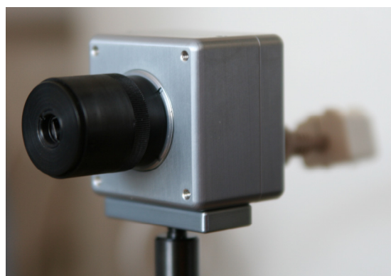
Obr.8: Maticový objektiv pro detekci tvaru vlnoplochy
