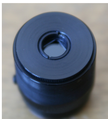
Obr.8: Maticový objektiv pro detekci tvaru vlnoplochy
