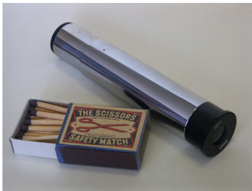
Obr.5: Konstrukce funkčního vzorku stříhového interferometru
