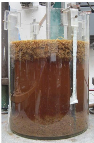
Obr. 17. Substrát v míchaném fermentoru při výrobě bioplynu.
