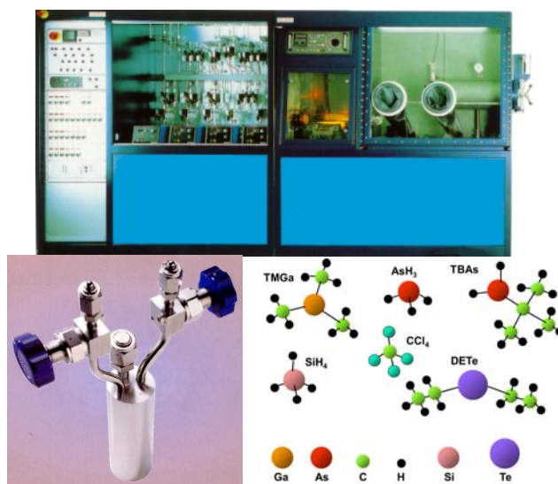
Obr. 8. a) Fotografie MOVPE aparatury Aixtron 200, b) Nerezová nádobka (bubler) na organokovy, c) schematicky znázorněné některé organokovové molekuly používané pro MOVPE růsty.
