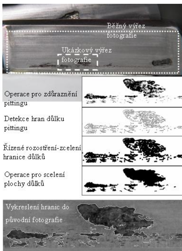
Obr. 4.1 Operace pro zdůraznění pittingu [2], [31], [33]
