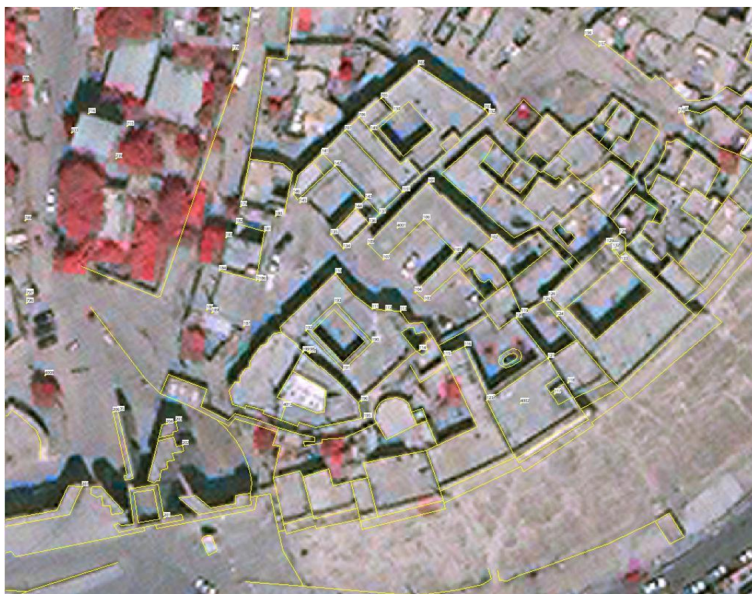
Obr.37: Prostorové vyhodnocení v programu Photomodeler a polohové v sw Topol
