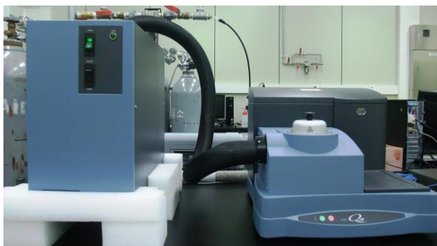
Obr. 66 Přístroj DSC Q100 od firmy TA Instruments pro provedení diferenční skenovací kalometrie
