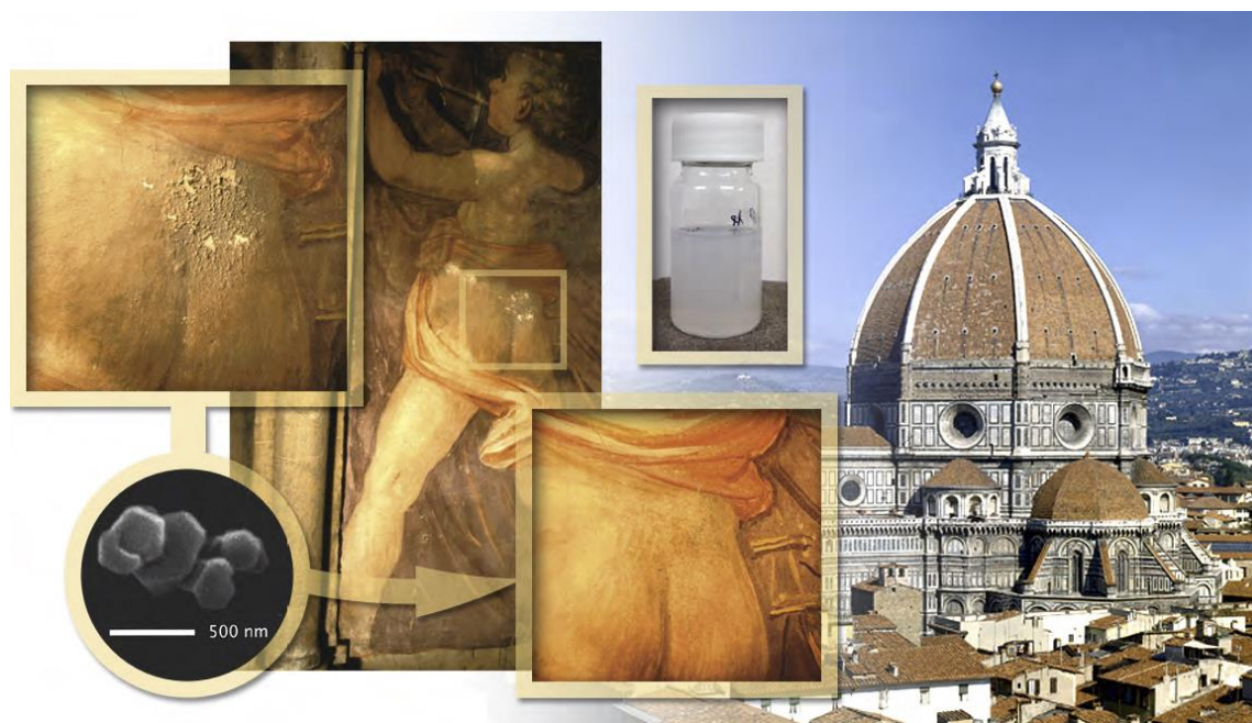
Obr. 41 Příklad úspěšné aplikace nanočástic vyvíjených firmou Nanorestore při konsolidaci nástěnné malby v chrámu S. Maria del Fiore ve Florencii (zdroj: http://euronanoforum2015.eu/wp-content/uploads/2015/06/Baolioni-euronanoforum2015.pdf )
