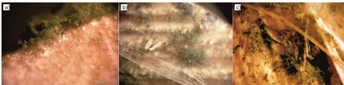
Obr. 52 Vzorky dřeva s nanotextiliemi: a) mikroskopický snímek růstu plísně na dřevěném vzorku opatřeném nanotextilií PVA po 32 dnech, b) mikroskopický snímek mycelia hub protkaných v celé struktuře nanovlákněné textilie PVA, c) poškozená nanotextilie PVA s biocidem v infikovaném dřevě
