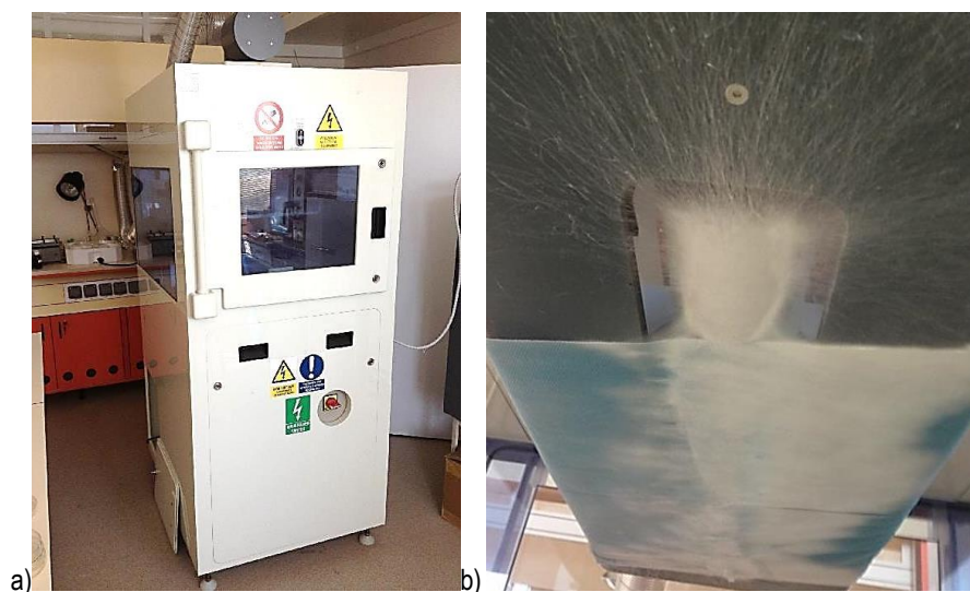
Obr. 58 a) fotografie zařízení Nanospider; b) pohled do jeho komory během výroby netkané nanotextilie (laboratoře Fakulty stavební ČVUT v Praze (Foto R. Zígler)
