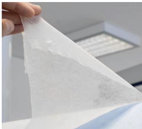
Obr. 56 Příklad nanotextilie vyrobené zvlákněním PUR, která vykazuje vysokou pružnost (Foto Pardam s.r.o.)
