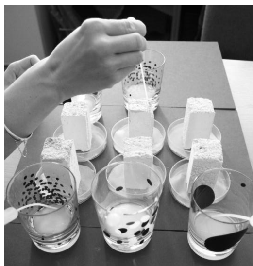
Obr. 125 Aplikace konsolidantů pro zjištění hloubky penetrace
