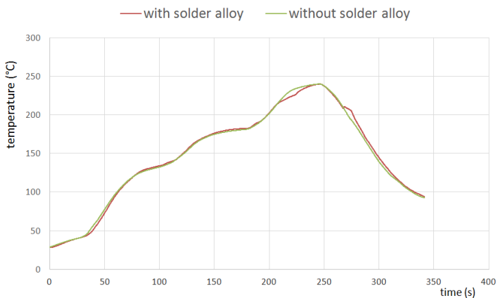
Obr. 9: Naměřené teplotní profily pro pájecí plošku bez přítomnosti pájecí slitiny a pro pájecí plošku, na které byla posléze přetavena pájecí slitina (25 mg, Sn96,5Ag3Cu0,5)
