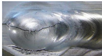
Obr. č. 13 - Trhlina za tepla (koncový kráter)
