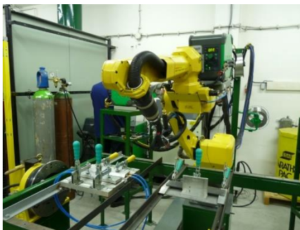
Obr. č. 19 – Robotické pracoviště se svařovacími přípravky pro zkoušku podle Houldcrofta (vlevo) a pro zkoušku na T-spoji (vpravo)
