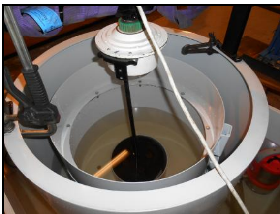
Obr. č. 5 Dvouplášťová verze kašnové miniturbíny pro spády do 1 m
