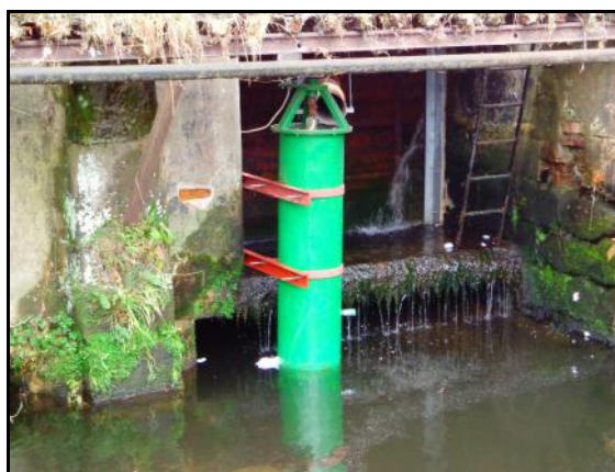
Obr. č. 4 Barelová verze miniturbíny s horním nátokem vody
