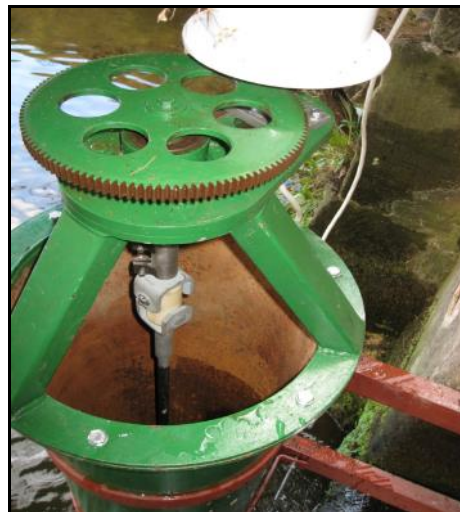
Obr. č. 10 Příklad zavěšeného rotoru u kotlové (barelové) verze turbíny
