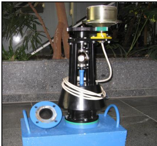
Obr. č. 9 Komerční mniturbína s podepřeným rotorem pro spády do 15 m a průtoky do 15 l/s
