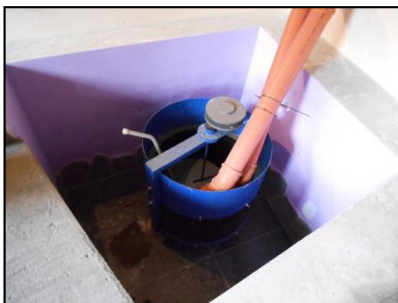
Obr. č. 6 Kašnová miniturbína pro velmi nízké spády s dvěma přívodními potrubími
