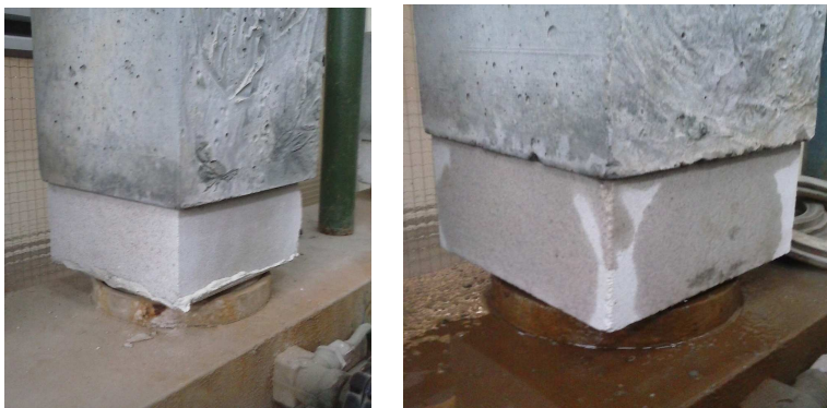
Obr. 13 – Vzorky vápenopískové cihly zatížené vodním tlakem (0,1 MPa). Vlevo: vzorek s aplikovaným krystalizačním nátěrem, vpravo: vzorek bez nátěru
