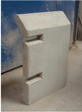
Obr. 2 – Vlevo: prototyp soklové tvarovky, vpravo: výřez části výrobní dokumentace
