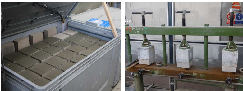
Obr. 12 – Vlevo: ošetřování vzorků s aplikovaným krystalizačním nátěrem, vpravo: vzorky ve vodotlačné stoličce, zatížené vodním tlakem 0,1 MPa.
