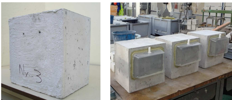
Obr. 9 – Vlevo: Zkušební těleso z betonu C 20/25 s navrtanými otvory pro kartáčové sondy, vpravo: Zkušební sestava - těleso s připojenou nádobou a s krystalizačním nátěrem
