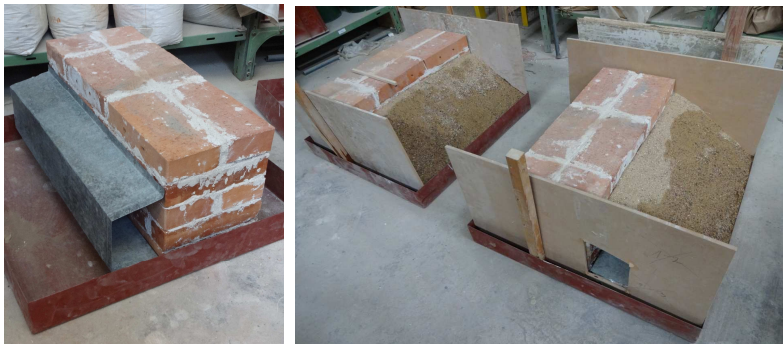
Obr. 5 – Analýza účinnosti provětrávané štolý prováděná na laboratorním modelu.
