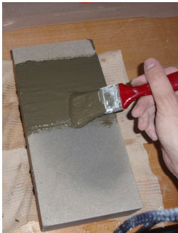
Obr. 11 – Vlevo: aplikace krystalizačního nátěru na vzorek, vpravo: vápenopískové cihly s krystalizačním nátěrem zatížené hydrostatickým tlakem (10kPa)
