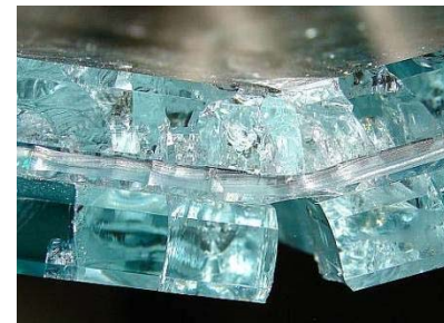
Obr. 4.4: Vrstvené sklo po porušení
