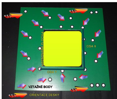
Obr. 11 – Navržená měřicí deska
