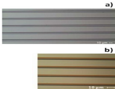
Obr. 2.4 Fotografie realizovaných ENR hřebenových vlnodů [21]
