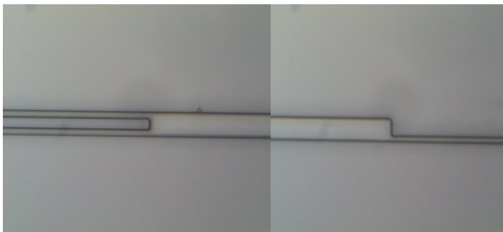
Obr. 2.6 Fotografie MMI filtru 1490 a 1550 nm realizovaného na substrátu \text{Si}/\text{SiO}_2 , s jádrem ENR a pláštěm PMMA elektronovou litografií. Optické vlnovody mají šířku 1,1 \mu\text{m} .
