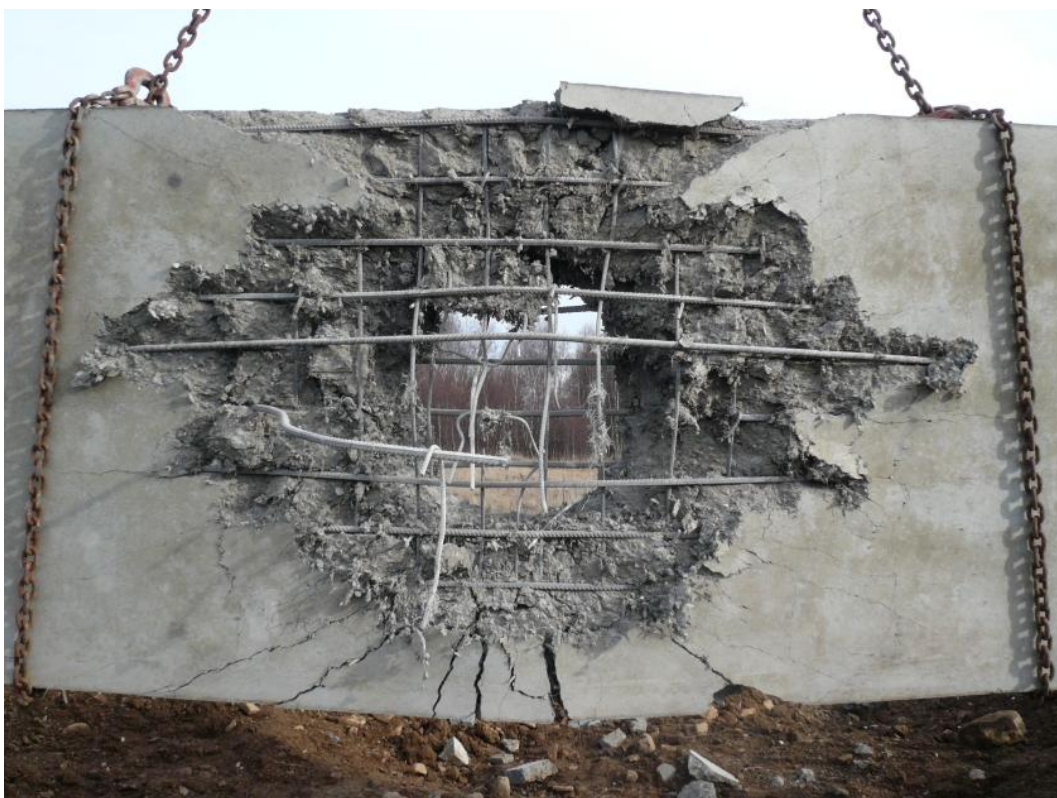
Obr. 10 – Vzorek č. 2 poškozený výbuchem – dolní povrch
