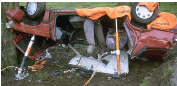
Obrázek 11 Stabilizace vozidla převráceného na střechu [10]
