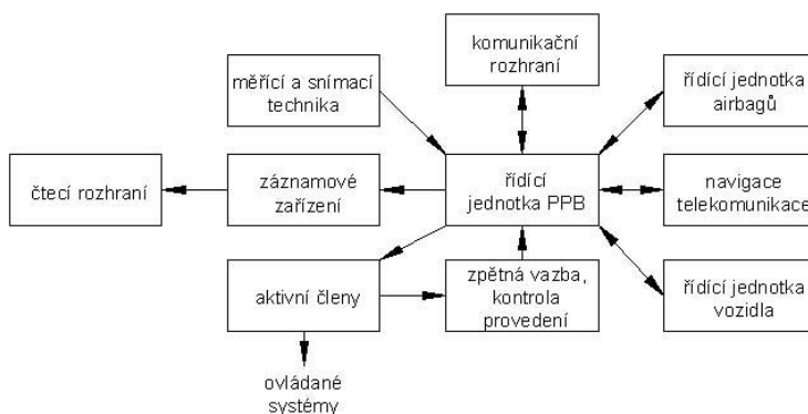
Obrázek 9 Blokové schéma obvodu ponehodové pasivní bezpečnosti
