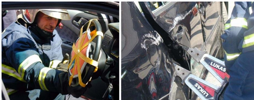
Obrázek 12 Nasazení krycího popruhu airbagu na věnec volantu, překonání dveřního zámku za použití vyprošťovací techniky
