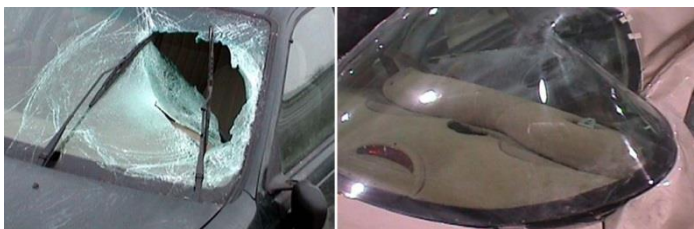
Obrázek 8 Vlevo vrstvené sklo, vpravo polykarbonát [4]
