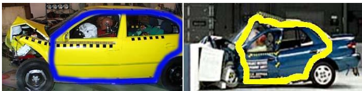
Obrázek 5 Chování nové a staré koncepce použitých materiálů při havarijním testování
