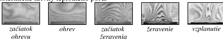
Obr. 2 Postupnosť vytvárania prúžkov pri ohreve skúšobných telies (PIVARČIOVÁ, 2002)
