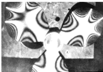
Obr. 20 Holografický interferogram vibrujúcej lodnej skrutky (PAVELEK, 2002)
