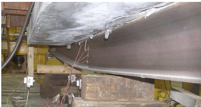
Obr. 7.: Zkouška spřaženého nosníku [31]
