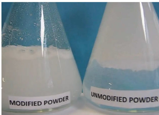
Obrázek 5: Porovnání smáčivosti plazmatem modifikovaného (vlevo) a nemodifikovaného práškového materiálu ve vodě (zdroj: www.surface-treat.cz ).
