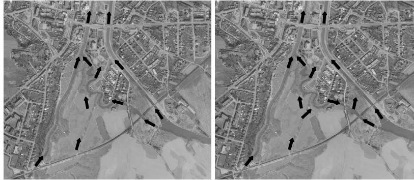
Obr. 3 Hlavní směry proudění pro průtok Q_{50N} (vlevo) a pro průtok Q_{50L} (vpravo)
