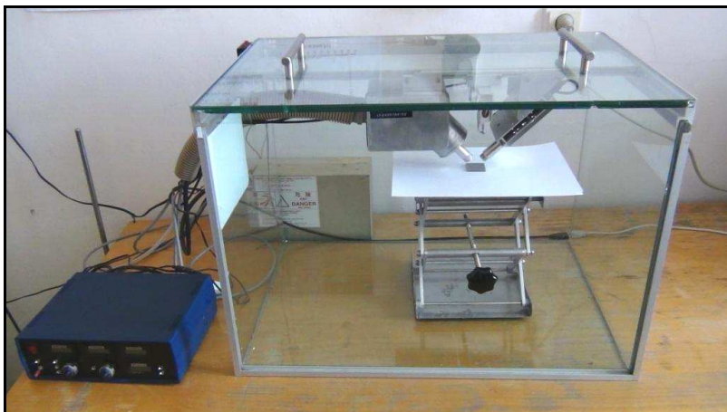
Obrázek 1: Fotografie aparatury pro rentgenovou fluorescenční analýzu. Ve skleněném boxu jsou v horní části umístěny miniaturní rentgenka (vlevo) a Si-PiN detektor (vpravo).
