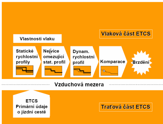
Obr. 9. Princip výpočtu kontroly rychlosti vozidla, zdroj [13]
