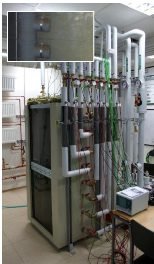
Obr. 11 Stratifikační zásobník tepla s detailem stratifikační vložky[13]
