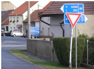
Obr. 1.9 Příklad špatného svislého dopravního značení před křižovatkou (Žebrák).
