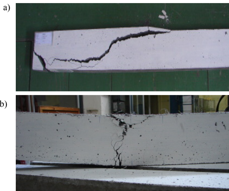
Obr. 4.7 Charakter porušení trámů 100/150/1800mm z hutného betonu s pórovitým kamenivem Liapor s prutovou výztuží 2\phi 6 z oceli B500A a) bez vláken - porušení smykem b) vlákna Forta Ferro 0,5% - ohybem [ Kohoutková a kol. 2006]
