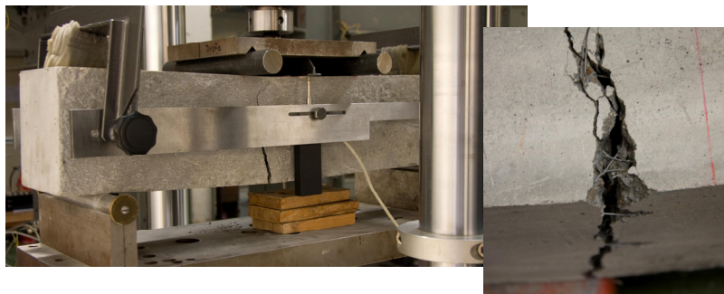
Obr. 4.2 Zkouška trámku ohybem – vláknobeton s ocelovými vlákny [Petřík, 2004]
