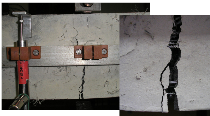
Obr. 4.3 Zkouška trámku ohybem - vláknobeton s polymerovými vlákny
