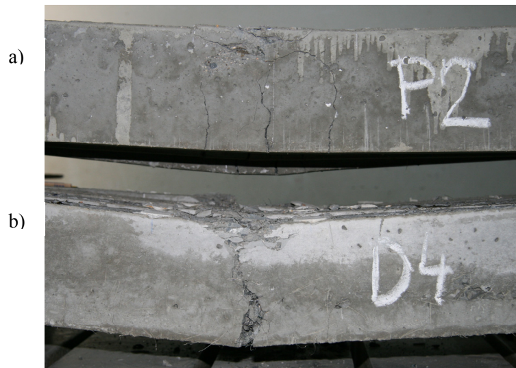
Obr. 4.5 Porovnání porušení trámů po zkoušce ohybem (popis viz obr.4.4)
