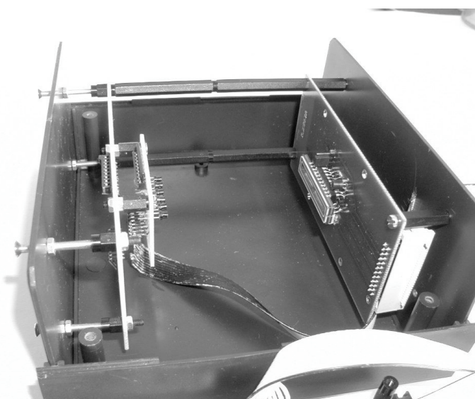
Obr. 2.15 Příklad uspořádání pokusné hlavice snímače
