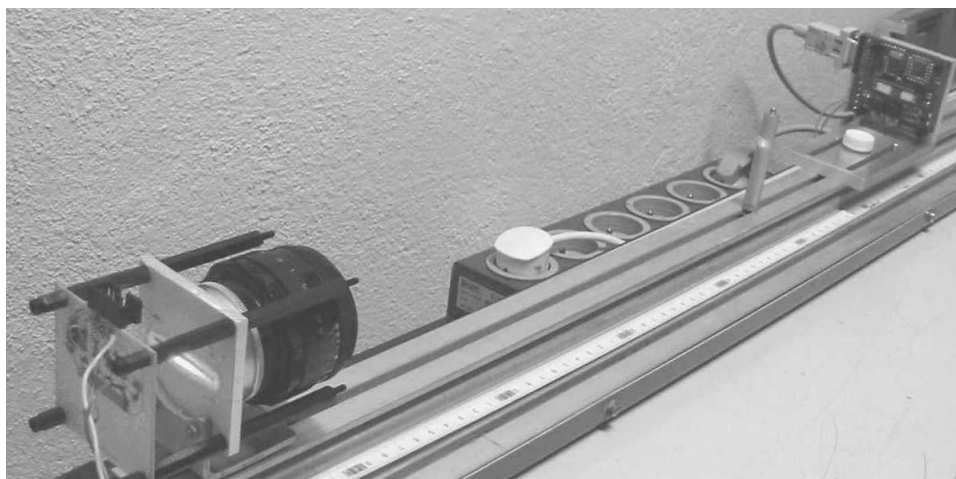
Obr. 2.10 Experimentální snímač s kolimátorem
