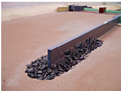
Obr. 12 Hydraulický model dělící zdi horní rejdy.
