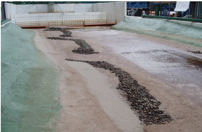
Obr. 4 Hydraulický model soustředovacích výhonů v laboratoři.
