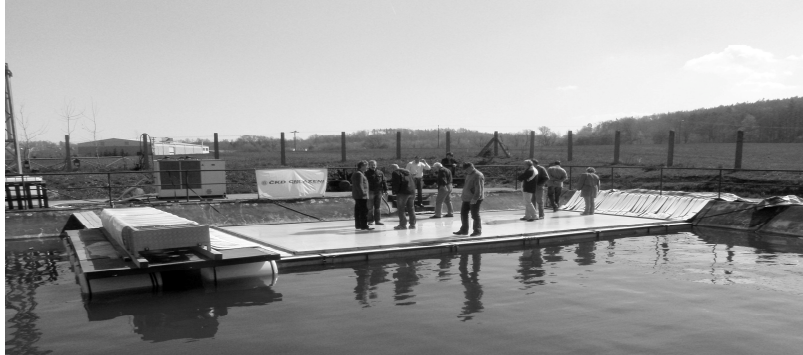
obr. 14c – experimentální ověření nautických vlastností plující ledové plochy 10 x 5 m, snímky ze zatěžovací zkoušky
