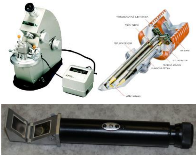
Obr. 1: Ukázka klasického Abbe refraktometru s externím termostátováním – vlevo, řez procesním refraktometrem firmy K-Patents – vpravo a příklad ručního refraktometru - dole.
