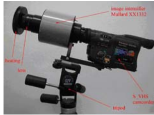
Obr. 2 Kamera s optickým zesilovačem obrazu Mullard pro televizní sledování meteorů.
