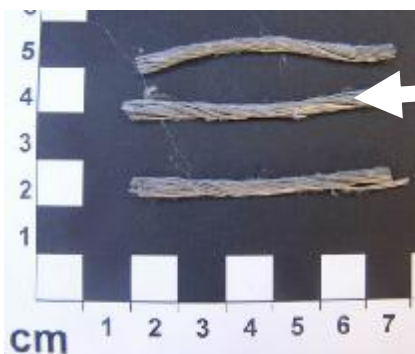
Foto 3. Celkový pohled na sdužená PP vlákna vlevo složená sdužením PP makrovláken Forta Ferro (vpravo) délky 56 mm
