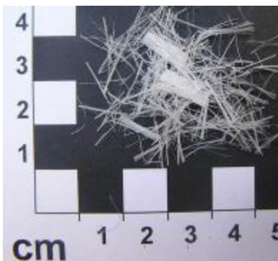
PP vlákna Crackstop-12 mm
