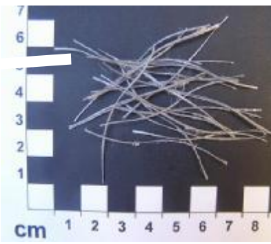
Foto 3. Celkový pohled na sdužená PP vlákna vlevo složená sdužením PP makrovláken Forta Ferro (vpravo) délky 56 mm
