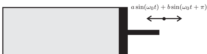
Obrázek 4.7: Dvoufrekvenční buzení stojaté vlny uvnitř válcového rezonátoru.
