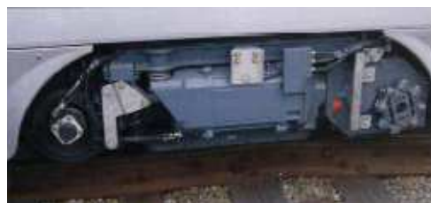
Obr. 23 Normálněrozchodný podvozek tramvaje Cityrunner 3001 a jeho zabudování pod skříní vozidla (zdroj - Bombardier Transportation [11] )
