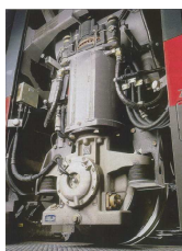
Obr. 10 Tříčláneková, čtyřnápravová nízkopodlažní tramvaj s jednonápravovými portálovými podvozky v uspořádání pojezdu 1'A_0\bar{A}_0'A_0 .
