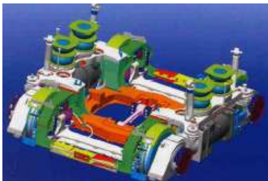
Obr. 18 Zmodernizovaný dvounápravový trakční podvozek SF 30 TF pro rozchod 1435 mm ( zdroj – Siemens [11] )
