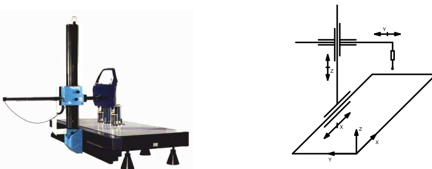
Obr. 3 Souřadnicový stroj s výsuvným horizontálním ramenem a jeho kinematický model
