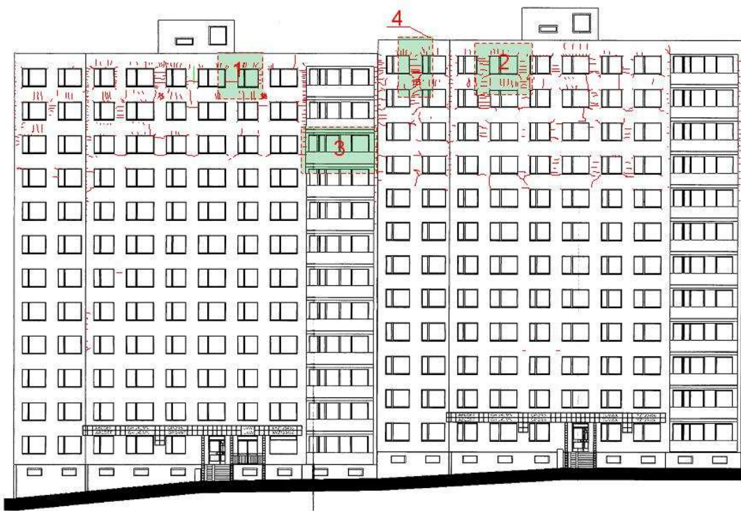
Obr. 4: Zákres poruch omítky západní fasády jednoho z vybraných objektů
