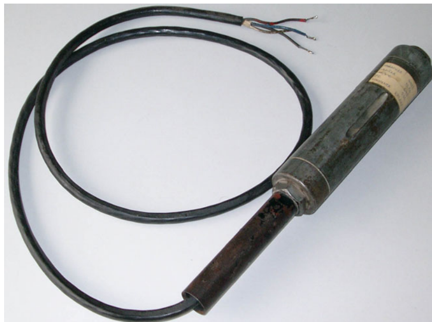
Obrázek 5: Přehradní tenzometr pro dálkové měření napjatosti masivních betonových a železobetonových konstrukcí, jejichž modul pružnosti je větší než E = 1.5 \cdot 10^4 MPa. Délka 282 mm, frekvenční rozsah 620 – 1030 Hz.
