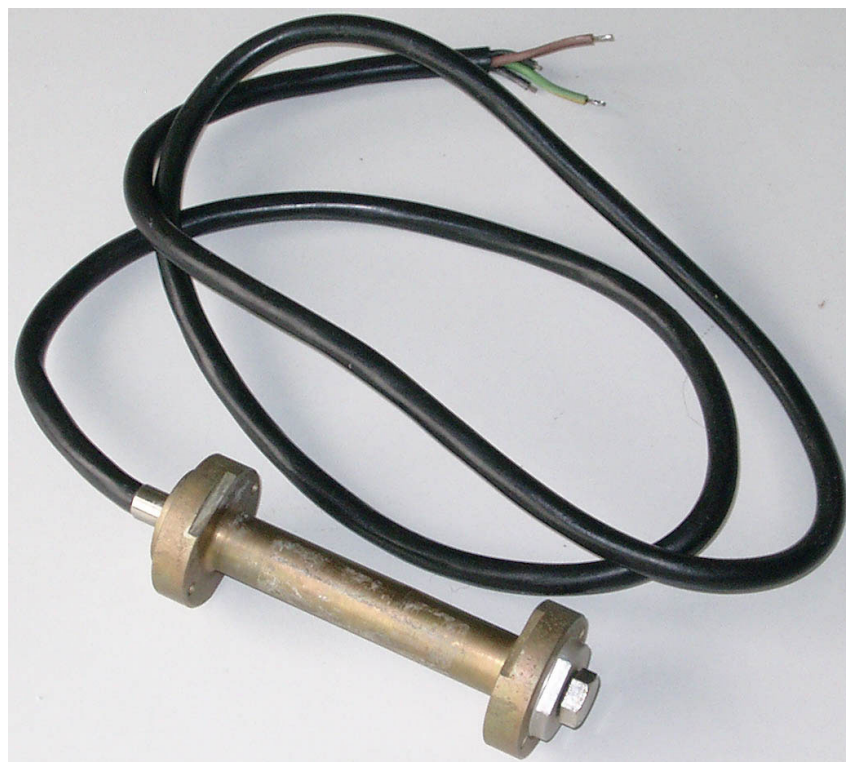
Obrázek 4: Ponorný tenzometr pro měření napjatosti předpjatých betonů s menším zrnem plnidla. Délka 128 mm, průměr hlav max. 42 mm, průměr střední části 18 mm, frekvenční rozsah 830 – 1670 Hz.
