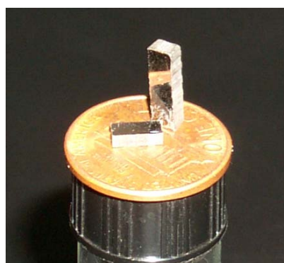
Obr. 4. Objemové vzorky monokrystalů (\text{Bi}_{1-x}\text{Sb}_x)_2\text{Se}_3 pro měření transportních veličin.
