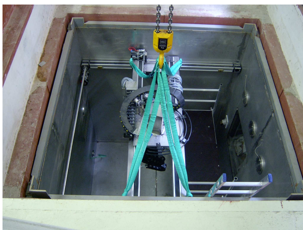
Obr.5.2 Pohled do odkrytého pracovního prostoru manipulátoru v jaderném výzkumu, na stěně jsou patrné otvory pro havarijní prostředky a průzor operátora
