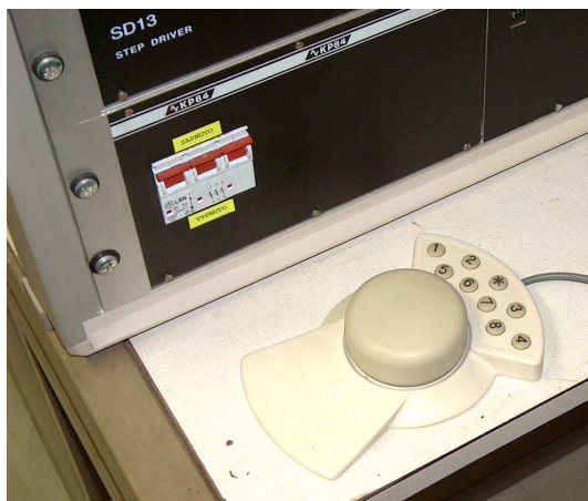
Obr.3.6 Ruční servoovládání motoricky poháněného manipulátoru
