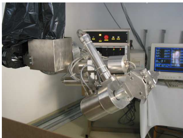
Obr.3.6 Ruční servoovládání motoricky poháněného manipulátoru
