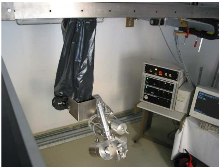
Obr. 4.1 Krytování konstrukce manipulátoru dekontaminační folií, před umístěním do pracovního prostoru
