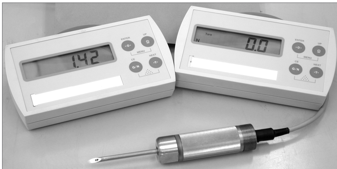
Obr. 9 - Celkový pohled na měřicí zařízení včetně obou vážních automatů WE
