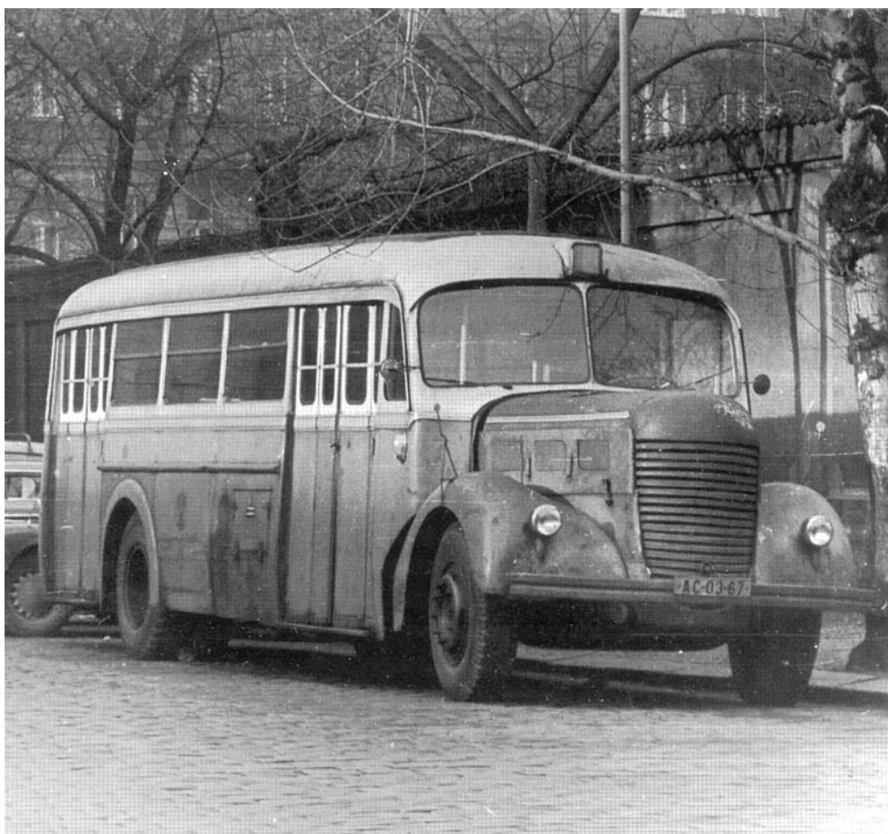
Autobus PRAGA NDO z roku 1948 (obr.str.203) – Charakteristický zástupce z dlouhé éry autobusů s již celosvařovanou ocelovou skříňí, má však stále ještě předstupující kapotu a motor vpředu. Toto uspořádání se udrželo dodnes u severoamerických speciálních tzv. „školních“ žlutých autobusů.
