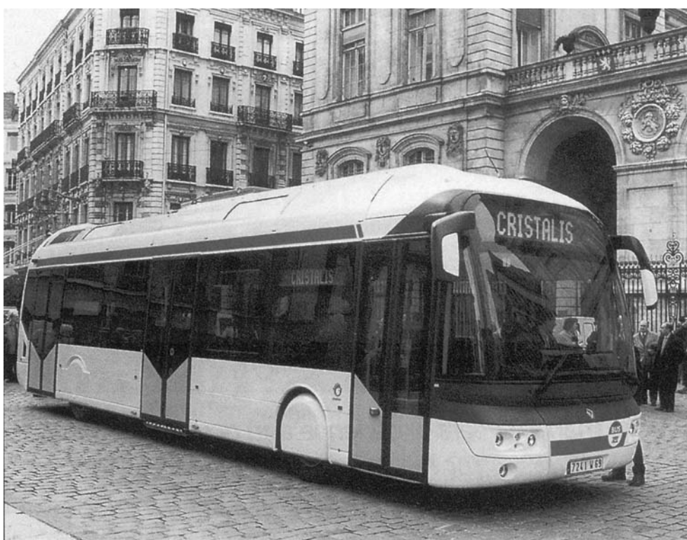
CIVIS – nová řada francouzského nízkopodlažního nekonvenčního vozidla – Vozidlo na bázi autobusu vyvinulo francouzské sdružení IRISBUS. Vyplňuje kapacitní mezeru mezi tramvajemi a autobusy či trolejbusy. Vozidlo je vybaveno tzv. optickým řízením, které umožňuje směrové fixování jízdní dráhy ve vozovce a v určených úsecích trasy automaticky řídí směr jízdy vozidla.
