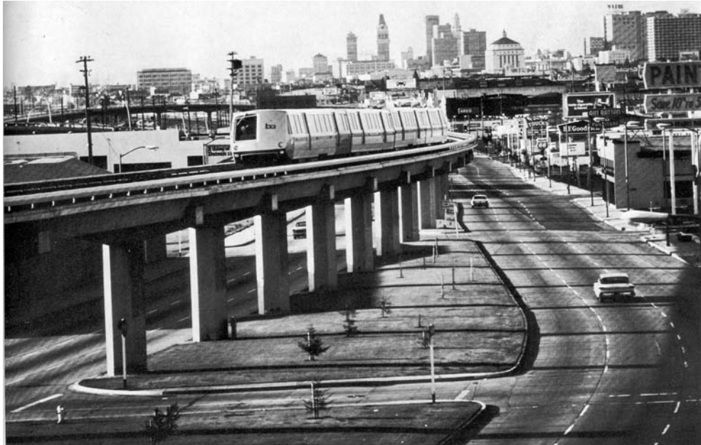
USA – SAN FRANCISCO – souprava expresního metra BART (Bay Area Rapid Transit) – Od doby svého vzniku v 70. letech 20. století je tato souprava symbolem přelomového designu, který výrazně ovlivnil další vývoj v navrhování souprav metra jak po konstrukční, tak po výtvarné stránce. Aerodynamicky nakloněné čelo s asymetrickým čelním sklem patří neodmyslitelně k obrazu metra v San Franciscu.
