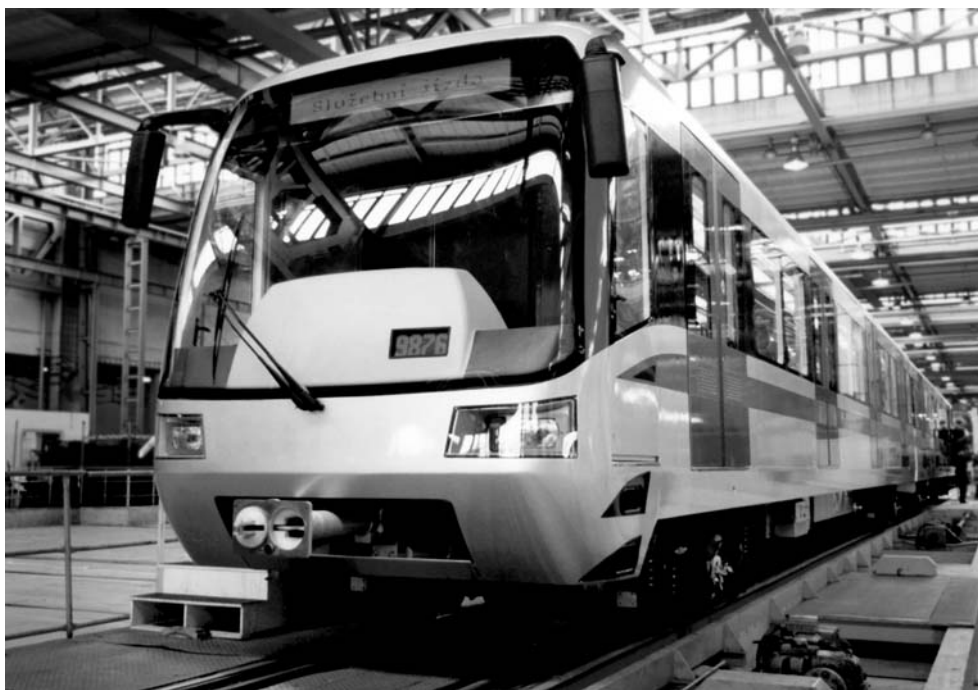
PRAHA – souprava nových vozů pražského metra M1 (design arch. Patrik Kotas, 2000) – Nová souprava vyráběná konsorciem SIEMENS-ČKD.ADTRANAZ reprezentuje klasickou koncepci pětivozové soupravy metra s moderní hliníkovou skříní. Čela soupravy jsou tvořena laminátovou skořepinou s velkoplošným vlepovaným sférickým sklem.
