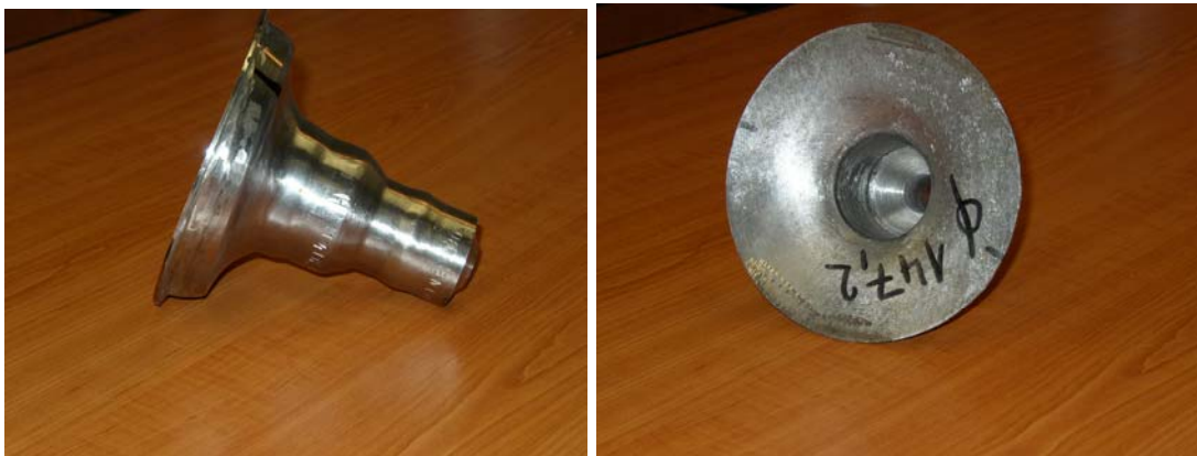
Obr. 18. Nátrubek odvodnění převáděcího potrubí vytažený za tepla (podle prof. Němce)
