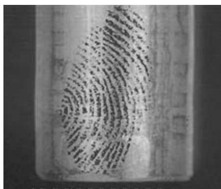
Obr. č. 12. Zjištění stop znečištění po doteku ruky na obrobeném povrchu.
