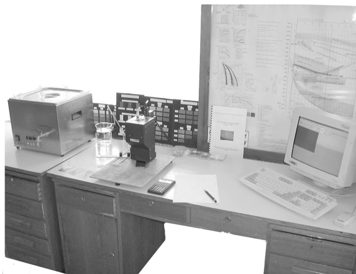
Obr.č. 10. Výzkumné pracoviště pro detekci zbytkového zamaštění na pracovišti povrchových úprav na Ústavu strojírenské technologie na FS - ČVUT v Praze.
