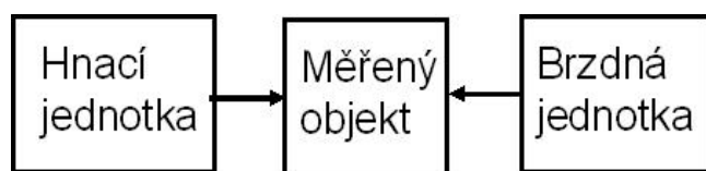
Obr. 1.1 Základní schéma otevřeného zkušebního okruhu
